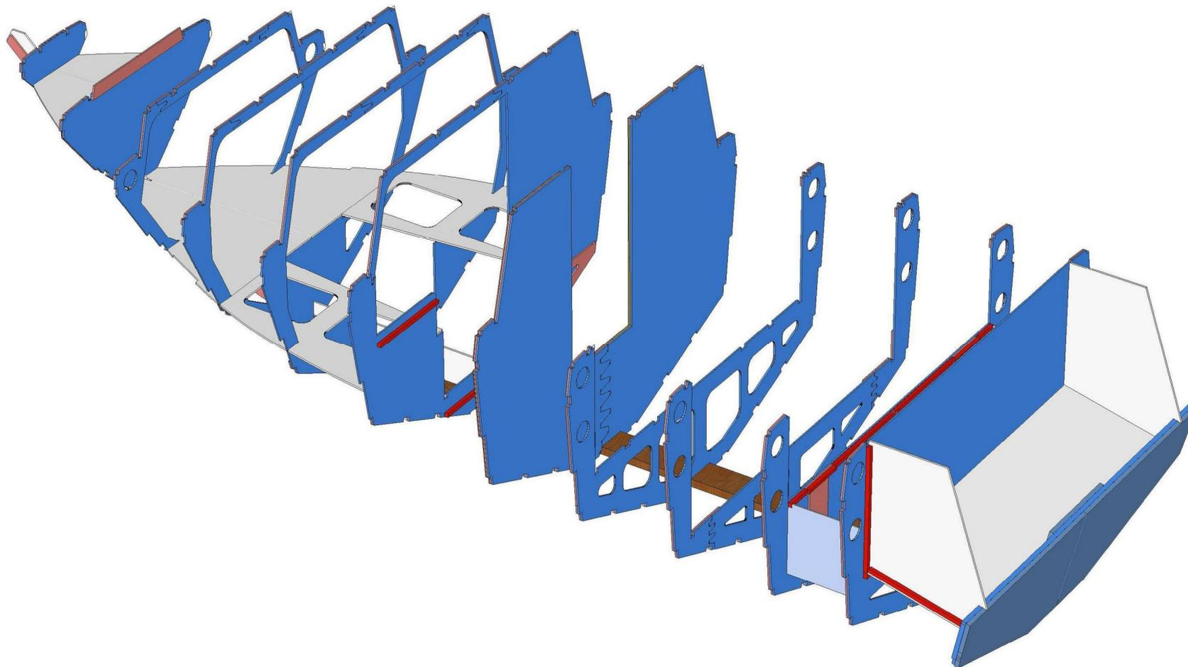
Обшивка рубки, палуба, детали кокпита, обшивка днища и бортов в набор не входят.
