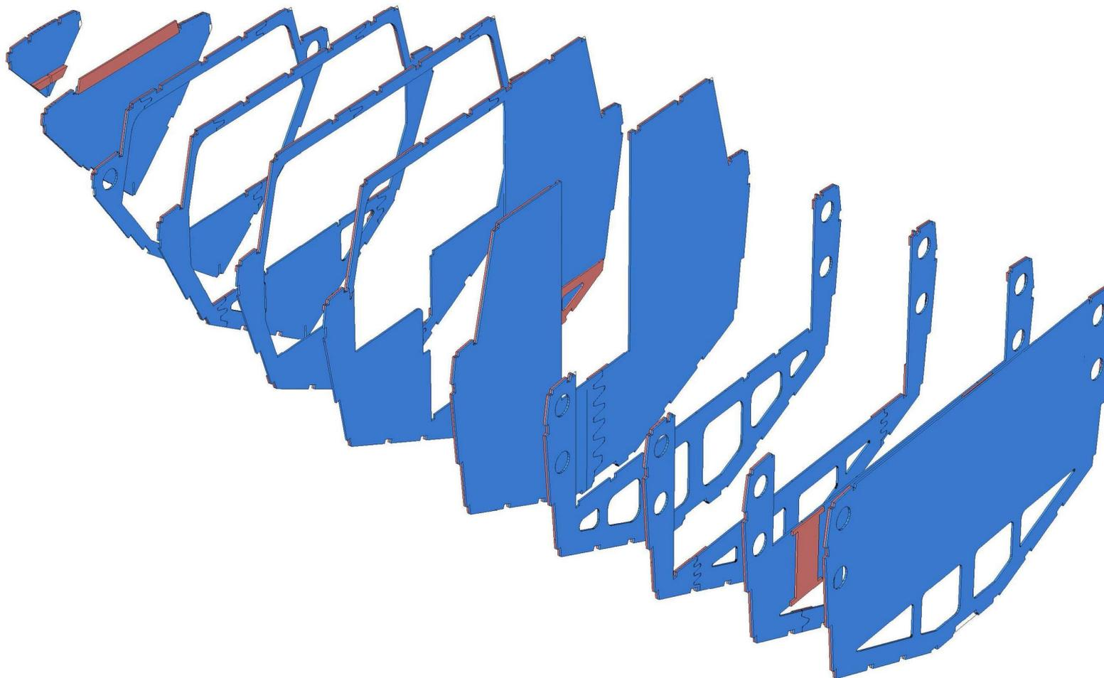
Транец, килевая балка, обшивка рубки, палуба, детали кокпита, обшивка днища и бортов и проч. в набор не входят. Показаны все детали в наборе.
